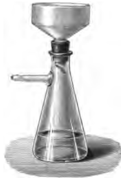
Nutschenfilter mit Gummiring auf eine Saugflasche aufgedichtet.
